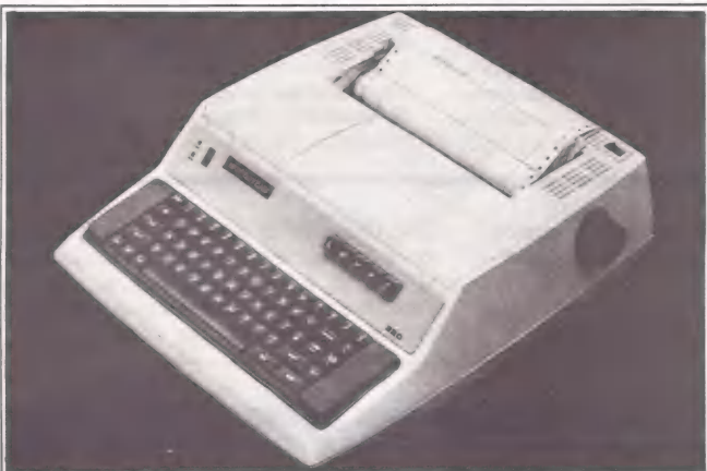
Um dos quatro modelos da Stratus – o 320 – possui teclado eletrônico com 60 teclas
